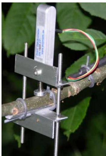
Dendrometer för kontinuerlig mätning av tillväxt
